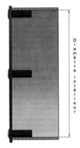
Figure 2 - Montage par l'intérieur
